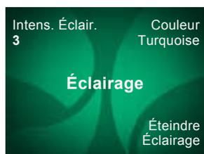
Séquence d'intensité d'éclairage : Intens. d'éclairage 3 = niveau d'éclairage élevé, Intens. d'éclairage 2 = niveau d'éclairage moyen et Intens. d'éclairage 1 = niveau d'éclairage bas.
